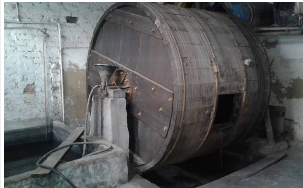
Foto No. 3 y 4. Bombos de proceso húmedo sin funcionamiento y sin generación de ARnD.
